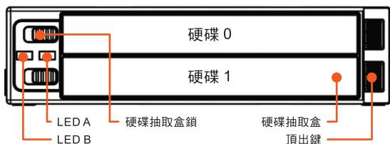
**NOTE** 當硬碟鎖位於右邊時，硬碟抽取盒將處於鎖住狀態，此時請勿按壓「頂出鍵」以避免抽取盒及硬碟鎖受到損傷。
