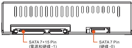
**NOTE** 接接電源線時，若發現無法接上，請確認接頭是否上下顛倒，若上下顛倒連接，將會導致系統不正常或機板燒毀。
